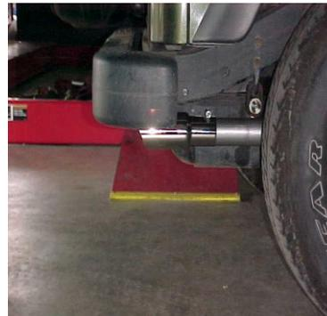
**MAKE SURE YOU HAVE A 1" CLEARANCE ON ALL PIPES FROM ALL RUBBER BRAKE LINES, SHOCK BOOTS, TIRES, ETC.**
