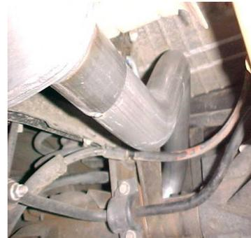
INSTALL MUFFLER # A ONTO FACTORY HEADPIPE USE CLAMP # C TO SECURE. DO NOT TIGHTEN. OUTLET OF MUFFLER SHOULD BE AT THE 9 O'CLOCK POSITION.
