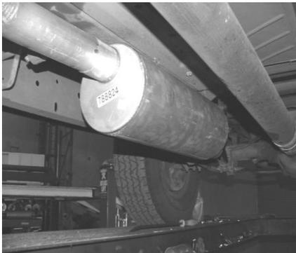
NEXT, CONNECT THE MUFFLER # B TO THE HEADPIPE USING CLAMP # F. USE JACKSTAND TO SUPPORT THE MUFFLER. THE OUTLET OF THE MUFFLER WILL BE AT APPROXIMATELY 9 O'CLOCK. THE MUFFLER INLET IS LOOKING INTO THE LOUVERS.
