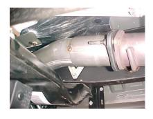
RE-INSTALL YOUR CATALYTIC CONVERTER TO THE NEW DOWN PIPE.
