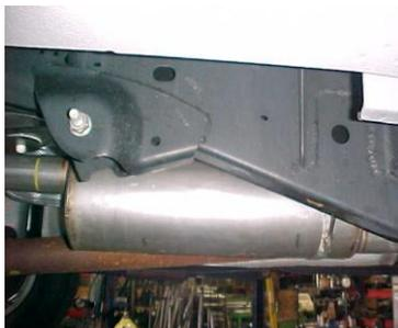
INSTALL MUFFLER # B ONTO HEADPIPE 1 1/2" TO 2". USE CLAMP # E TO SECURE MUFFLER TO HEADPIPE. DO NOT TIGHTEN. USE A JACK STAND TO HOLD UP THE MUFFLER. MUFFLER INLET IS LOOKING INTO THE LOUVERS. OUTLET SHOULD BE AT THE 10 O'CLOCK POSITION.
