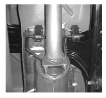
INSTALL HANGER #F ON THE OUTLET OF THE MUFFLER. DO NOT TIGHTEN. HANGER WILL BE FACING TOWARDS PASSENGER SIDE FRAME RAIL.
