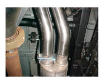
INSTALL REAR MUFFLER HANGER #E ONTO DRIVERS SIDE MUFFLER OUTLET. INSERT HANGER INTO RUBBER GROMMET LOCATED JUST BEHIND THE DRIVERS SIDE OUTLET. DO NOT TIGHTEN.
