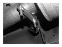
ADJUST MUFFLER ASSEMBLY FOR TAILPIPE EXITS.
