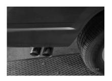
MAKE SURE YOU HAVE A 1" CLEARANCE ON ALL PIPES FROM ALL FUEL, BRAKE LINES, SHOCK BOOTS, TIRES, ETC.
