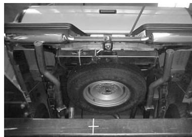
**MAKE SURE YOU HAVE A 1" CLEARANCE AWAY FROM ALL BRAKE LINES, FUEL LINES, SHOCKS, TIRES, ETC.**
