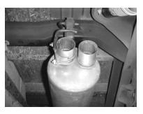
INSTALL MUFFLER #C. THE INLET OF THE MUFFLER WILL HAVE THE OPEN LOUVERS FACING FORWARD GRABBING THE EXHAUST. MAKE SURE THE MUFFLER OUTLETS ARE POSITIONED AT THE TOP OF THE MUFFLER. INSTALL HANGER #H ON THE DRIVER SIDE OUTLET OF THE MUFFLER OUTLET ON DRIVERSIDE. DO NOT TIGHTEN.
