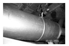
INSTALL PASS. SIDE OVER-AXLE PIPE # D INTO MUFFLER OUTLET 1 ½"-2". USE CLAMP # L TO SECURE PIPE TO MUFFLER OUTLET. DO NOT TIGHTEN
