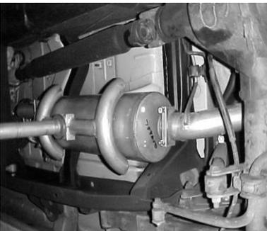
INSTALL MUFFLER TO HEADPIPES AND ATTACH CLAMP #G TO DRIVERSIDE AND CLAMP #H TO PASSENGER SIDE. INSERT HANGER INTO RUBBER GROMMET. MAKE SURE INLET AND MUFFLER IS LEVEL. NOW TIGHTEN DOWN. USE JACK STAND TO SUPPORT MUFFLER.
