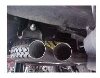
SLIDE DRIVERS SIDE TAILPIPE #B INTO MUFFLER 1-1/2" TO 2". NEXT SECURE TAILPIPE TOGETHER WITH BOLT KITS # H THE DRIVERS SIDE TABS ON PIPE SHOULD BE ON THE BOTTOM PASSENGER SIDE TAB.ON THE TOP. SECURE DRIVERS SIDE PIPE TO MUFFLER WITH REAR MUFFLER HANGER # E. DO NOT TIGHTEN.
