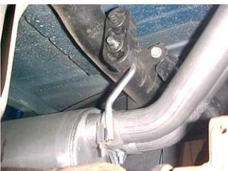
**5.** NEXT, INSTALL REAR MUFFLER HANGER #H ONTO DRIVER SIDE OUTLET OF THE MUFFLER. INSERT HANGER INTO RUBBER GROMMET DO NOT TIGHTEN.
