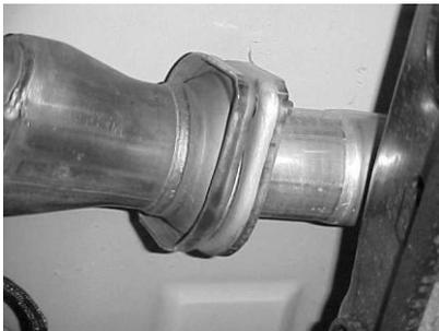
CONNECT HEADPIPE # A TO THE FACTORY FLANGE RE-USING THE FACTORY BOLTS. YOU MAY NEED TO APPLY A SMALL AMOUNT OF HI-TEMP GASKET SEALER TO THE FLANGE DOME TO INSURE A LEAK FREE CONNECTION.
