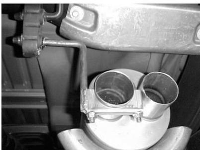
SLIP MUFFLER # B ONTO HEADPIPE # A NO MORE THEN 1-2" USE A JACK STAND TO SUPPORT THE MUFFLER. MAKE SURE THE MUFFLER OUTLETS ARE LEVEL. NOW INSTALL HANGER #E ON THE DRIVER SIDE OUTLET, AND INSERT WELDED HANGER INTO RUBBER GROMMET. DO NOT TIGHTEN
