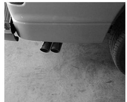
INSTALL YOUR STAINLESS TIPS. NOW TIGHTEN ALL CLAMPS AND HANGERS STARTING FROM THE MUFFLER BACK.
