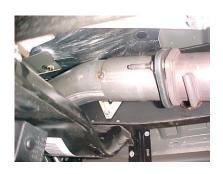
**RE-INSTALL YOUR CATALYTIC CONVERTER TO** THE NEW DOWN PIPE. USING YOUR FACTORY NUTS.
