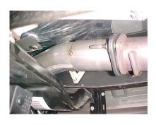
**RE-INSTALL YOUR CATALYTIC** CONVERTER TO THE NEW DOWN PIPE. USING YOUR FACTORY NUTS.
