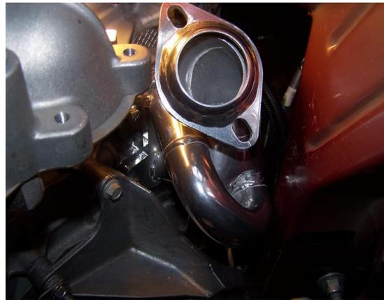
16. ONCE ALL BOLTS ARE SNUG. LOWER MOTOR BACK DOWN AND RE-TORQUE ENGINE MOUNT.
